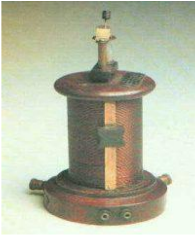
Radio de galena Sitti-Doglio de 1923, donde puede observarse el cuerpo cilíndrico de la bobina
